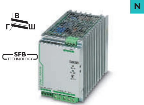
Источник питания, трехфазный, 48 В пост. тока, 20 А
